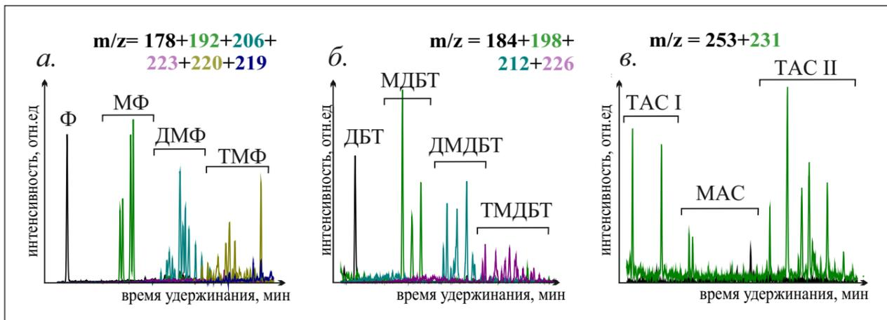
Рисунок 8 - Типовые хромото-масс-фрагментограммы ароматических соединений в битумоидах баженовской свиты: *а* - ароматические углеводороды фенантренового ряда, *б* - сероароматические соединения ряда дибензотиофена, *в* - моно- и триароматические стероиды
