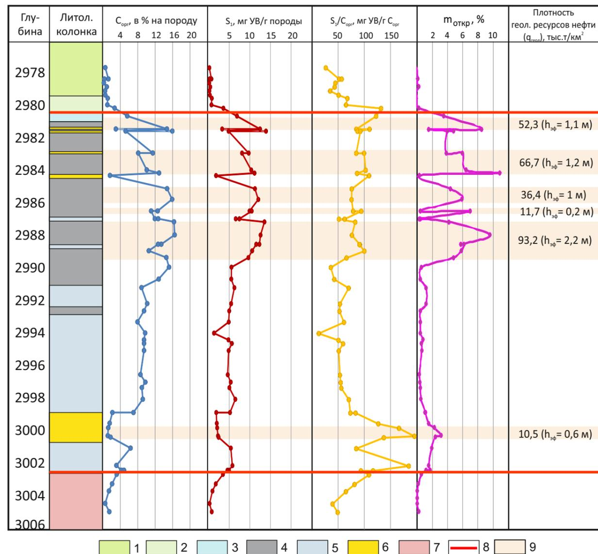
Рисунок 10 - Нефтенасыщенные интервалы в разрезе баженовской свиты в скважине Повховская-70 Северо-Сургутского района. Условные обозначения 1-8 см.на рис. 2; 9 - прослой с повышенными значениями открытой пористости
